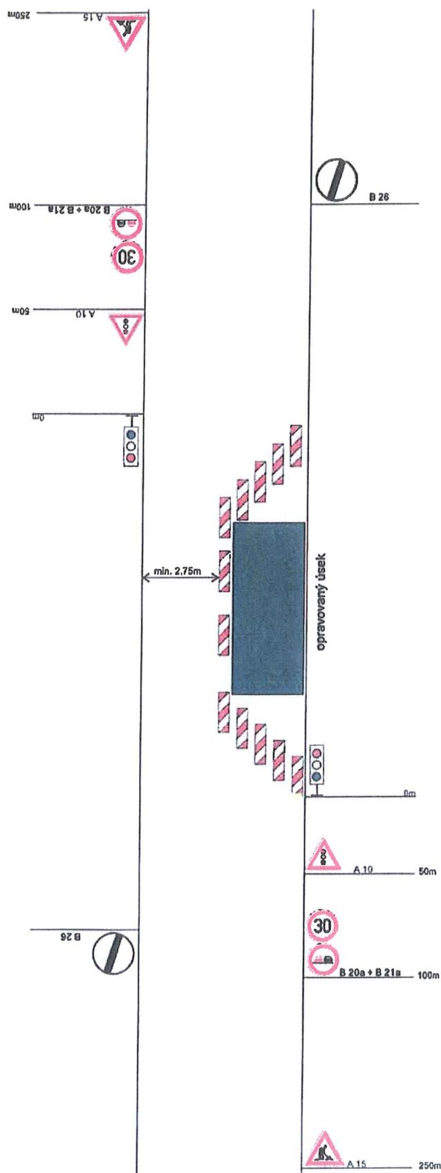
**SCHÉMA PDZ PRO UZAVŘENÍ LEVÉHO NEBO PRAVÉHO JÍZDNÍHO
