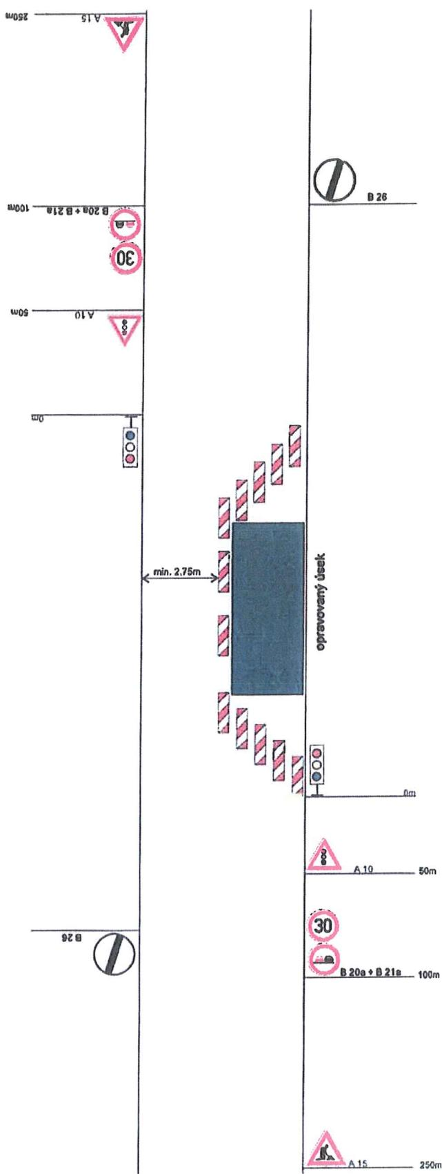
**SCHÉMA PDZ PRO UZAVŘENÍ LEVÉHO NEBO PRAVÉHO JÍZDNÍHO PRUHU NA ČTYŘPROUDOVÉ KOMUNIKACI:**
